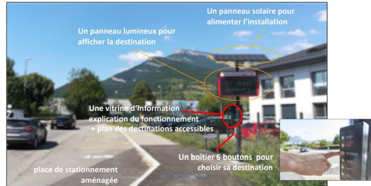
Arrêt réseau Synchro covoiturage (Chambéry) - Ecov 2020
