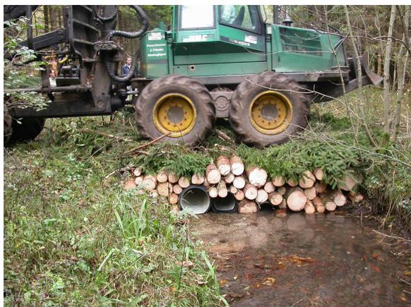
*Des solutions existent, parfois simples, comme ici la mise en place d'un dispositif rustique pour permettre le franchissement du cours d'eau par les engins de débardage*
