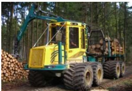
HSM : Pneus larges : 940 mm et bogies spéciaux pour une largeur de 3 m
