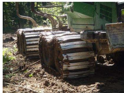
Equiper les engins de tracks à tuiles plates
